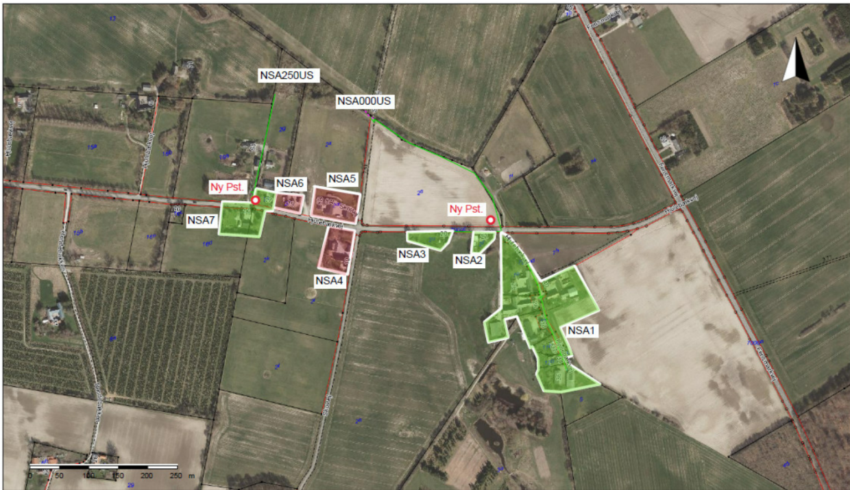
Figur 4 Afgrænsning af planlagte spildevands- og separatkloakerede oplande i Hjulebæk
