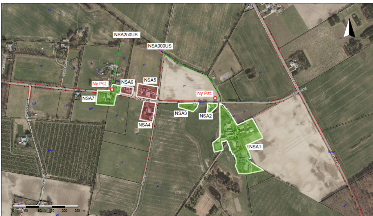
Figur 8 Afgrænsning af planlagte spildevands- og separatkloakerede oplande i Hjulebæk
