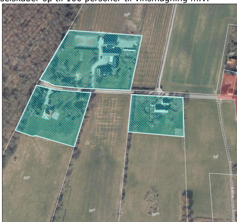
Figur 2. Vesterhavevej. 3 ejendomme (skraveret område) optages i spildevandskloakeret opland. Rødt område er det allerede planlagte spildevandskloakeret opland.
