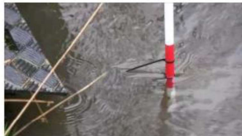
Figur 8 En landmålerstok med afsatte mærker for den ønskede vandstand er et simpelt og godt redskab til at sikre sig, at vandstanden holdes på det ønskede niveau.
