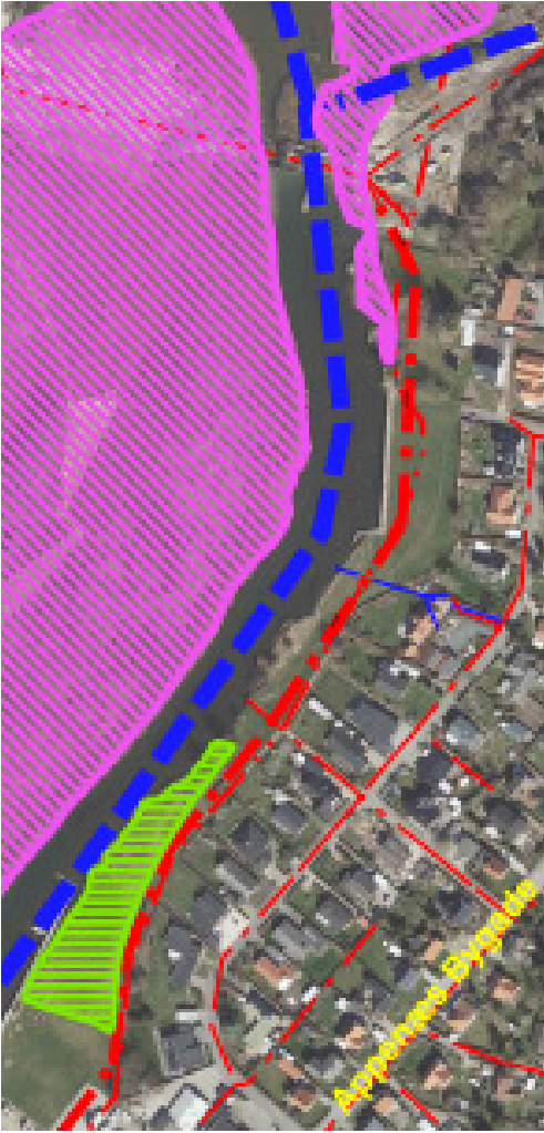
Figur 8. Forstørret uddrag af figur 1, hvor ledningstracéet fremgår med tyk, rød stiplede linje.
