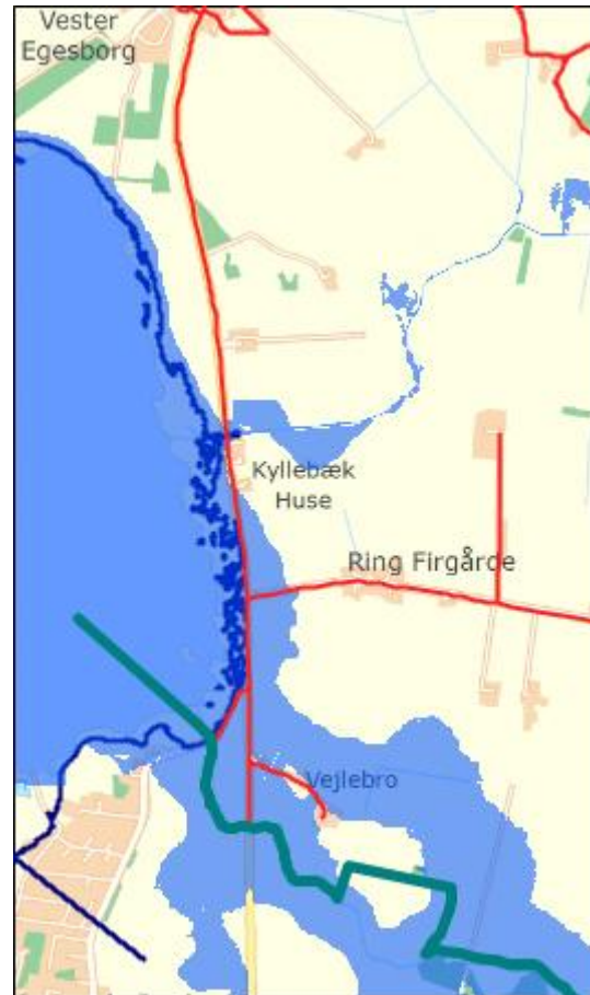
100-års stormflod 2110: Ved 100-års stormflod i 2110 vil Vordingborg Landevej efter nuværende forhold oversvømmes med næsten op til en meter og vandet vil dække større landbrugsområder syd for Ring.
