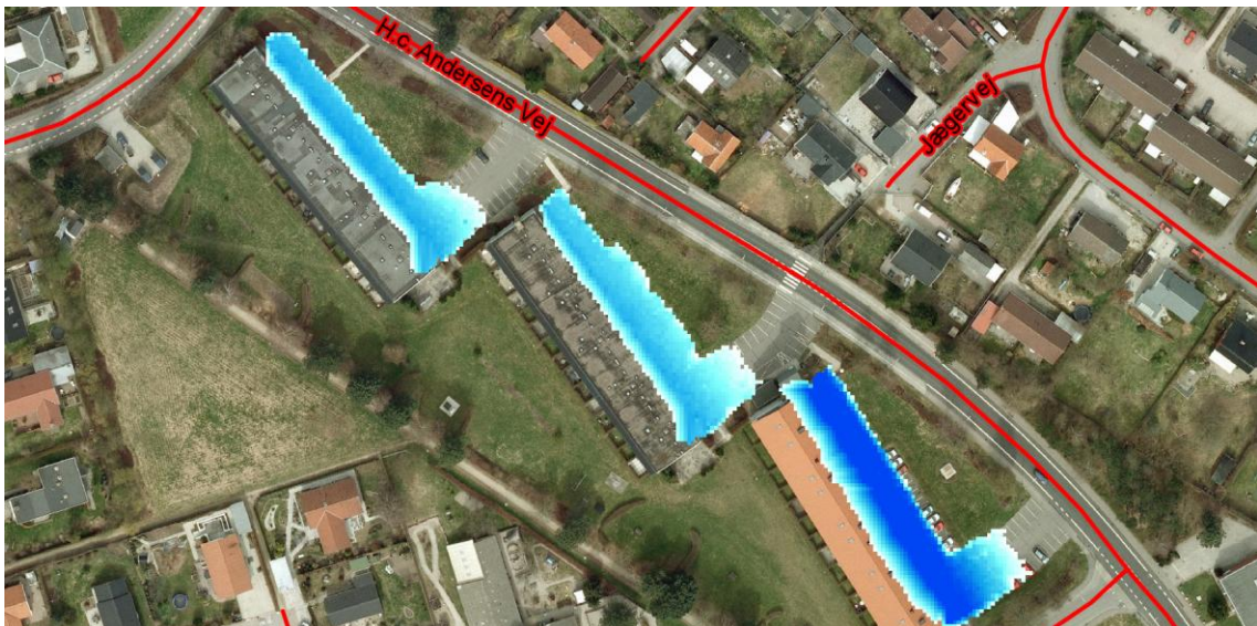
100-års regn (kloakanalyse) 2110: Kloakanalysen viser, at der er risiko for opstuvning af vand foran de 3 boligblokke på H C Andersensvej.
