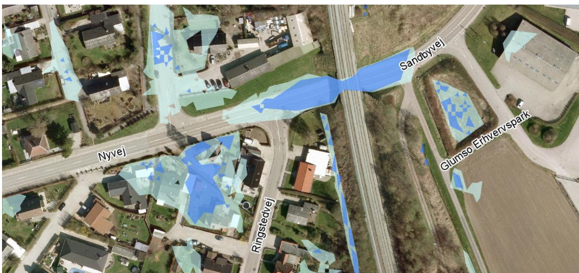
100-års regn (lavningsanalyse) 2110: Lavningsanalysen peger på, at der er risiko for, at der kan samles mere end 1 meter vand i tunnelen under Ringstedbanen ved en 100-års regn i 2110 (2010 beregningen viser næsten samme udbredelse).
