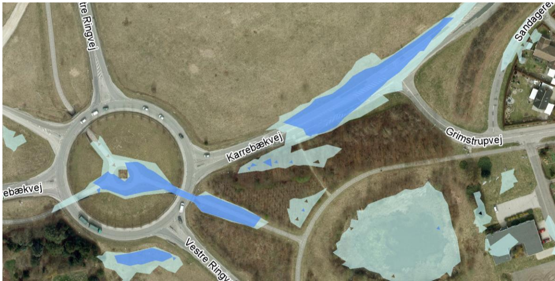
100-års regn (lavningsanalyse) 2110: Rundkørslen ved Karrebækvej/Vestre Ringvej. Lavningsanalysen viser, at der er risiko for at der samles vand på Karrebækvej, og at cykelstierne i rundkørselens midterø oversvømmes (den tilsvarende kloakanalyse peger dog ikke på problemer).
