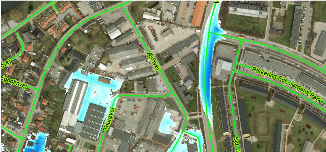
100-års regn (kloakanalyse) 2110: Kloakanalysen viser, at der er risiko for op mod 60 cm vand i de nordgående vejbaner på Indre Vordingborgvej. Kortet viser en 100 års regnhændelse i 2110. Udbredelsen af en 100 års regnhændelse i 2010 er ikke så meget mindre.
