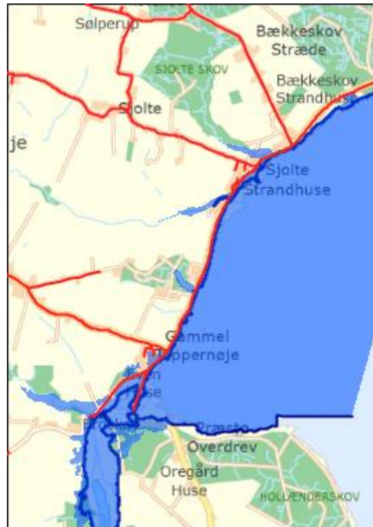
100-års stormflod 2110: Den blå linje viser den forventede kystlinje i 2110. Den simple terrænmodel der her er anvendt overdriver faren for oversvømmelse.
