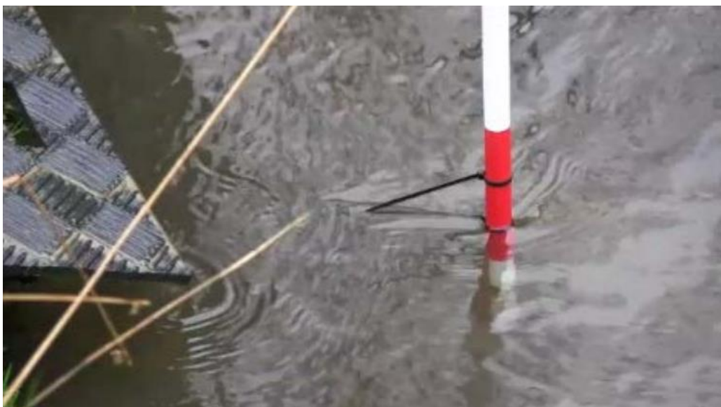
Figur 7.1: En landmålerstok med afsatte mærker for den ønskede vandstand er et simpelt og godt redskab til at sikre sig, at vandstanden holdes på det ønskede niveau (Kilde: Aqua DTU)
