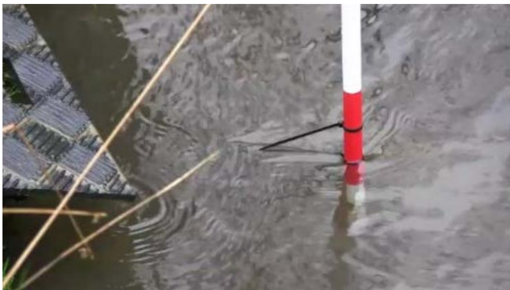
Figur 5.1: En landmålerstok med afsatte mærker for den ønskede vandstand er et simpelt og godt redskab til at sikre sig, at vandstanden holdes på det ønskede niveau (Kilde: Aqua DTU)
